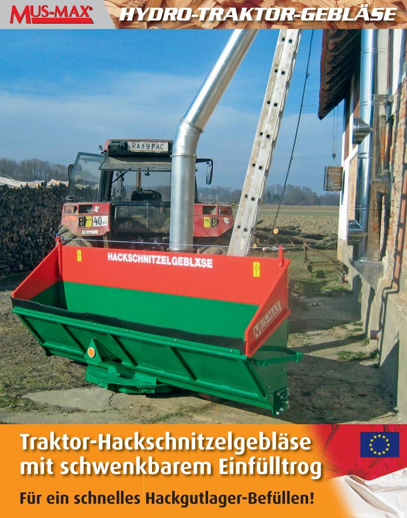
Das Hydro Traktor-Gebläse ist durch die niedere Bauhöhe leicht befüllbar und eignet sich auch zum Fördern von Pellets, Sägespänen u.a. Förderleistung: bis 50 m³/Std.
